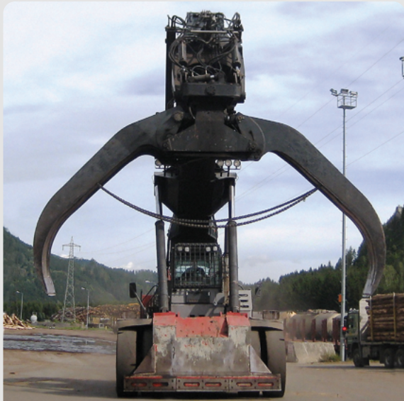
Přídržovací řetězy FB pro bezpečnou fixaci kmenů.
